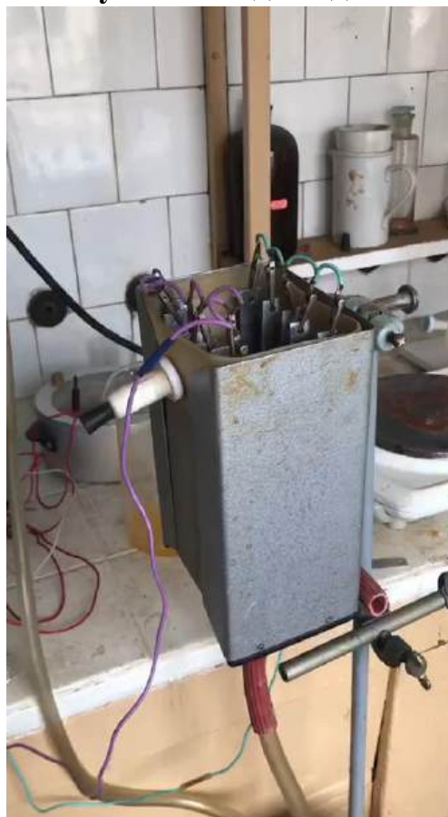
Рис. 1. Світлина установка для експериментального дослідження електрохімічного очищення стічних вод методом електрокоагуляції.
