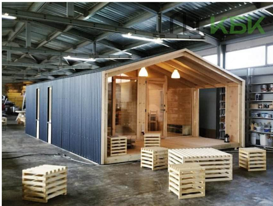
Рис.1. Приклад збірки каркасного модульного будинку в цеху
