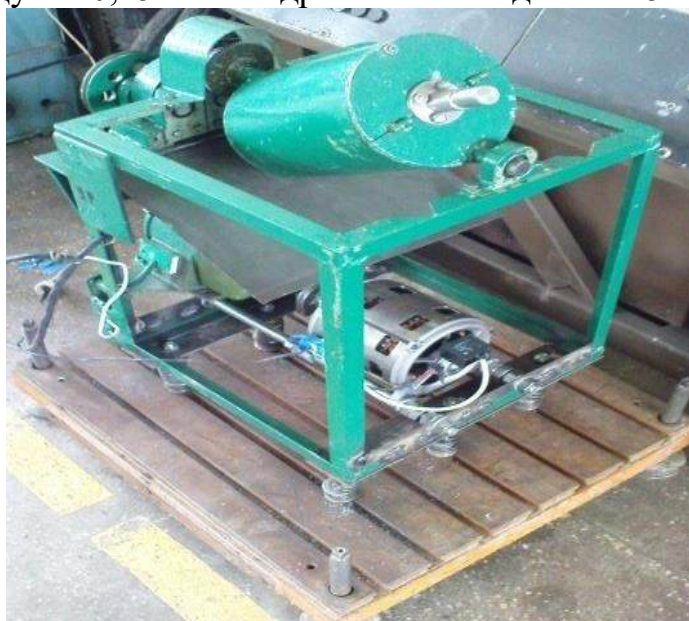
Рисунок 2. Загальний вигляд експериментальної установки для вібраційного подрібнення металічних порошків
