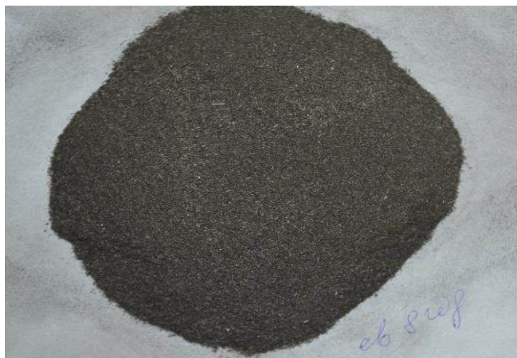
Рисунок 3. Порошок сірого чавуну марки СЧ18, отриманий із стружки під час точіння, після 8-ми годин обробки у млині
