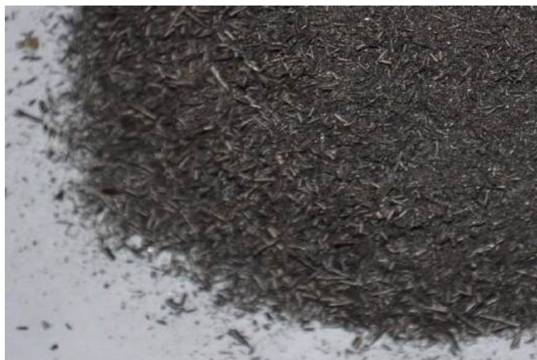
Рис. 1. Стружка сірого чавуну марки СЧ18 отримана під час точіння
