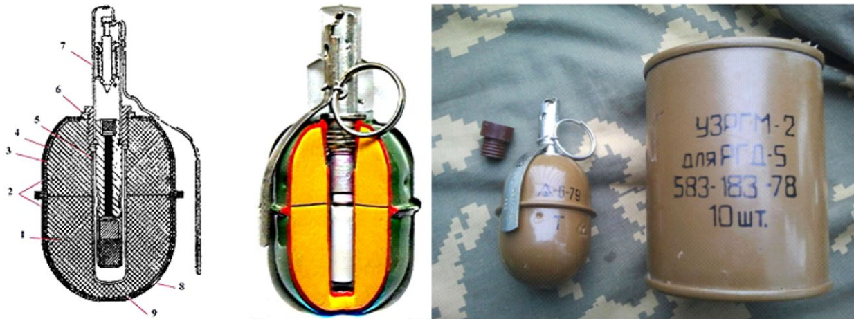
Рисунок 1. Будова ручної осколкової гранати дистанційної дії РГД-5 (57-Г-717): 1 – розривний заряд ( T = 0,110 кг); 2 – корпус; 3 – ковпак; 4 – вкладиш ковпака; 5 – трубка для запалу; 6 – манжета; 7 – запал УЗРГМ-2; 8 – піддон; 9 – вкладиш піддону
