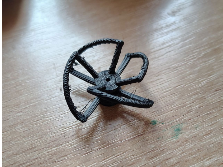
Рис. 2 Надрукована 3-D модель антени конюшини
