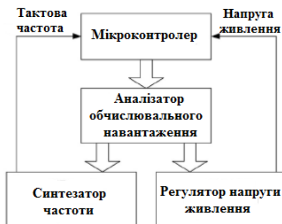
Рисунок 1. Структурна схема реалізації динамічної зміни напруги живлення і тактової частоти
